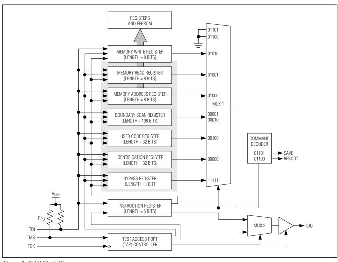
Figure 6. JTAG Block Diagram
