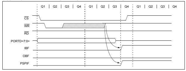
FIGURE 10-5: PARALLEL SLAVE PORT READ WAVEFORMS
