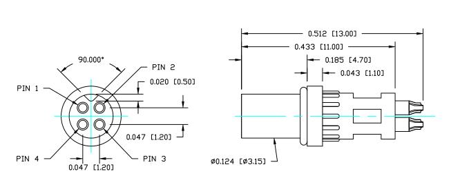
M5 FEMALE - CABLE MOUNT - SOLDER CUP - 4 POSITION
