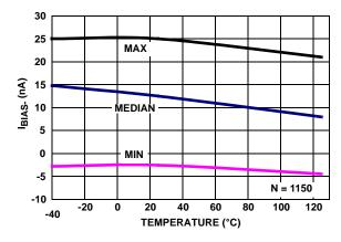
FIGURE 25. IBIAS- vs TEMPERATURE, V<sub>+</sub>, V<sub>-</sub> = ±2.5V
