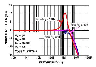
FIGURE 1. GAIN vs FREQUENCY vs FEEDBACK RESISTOR VALUES  $R_{\rm f}/R_{\rm g}$
