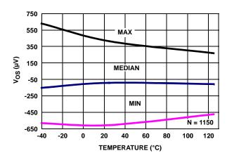
FIGURE 23. V<sub>OS</sub> (SOT PKG) vs TEMPERATURE, V<sub>+</sub>, V<sub>-</sub> = ±1.2V
