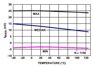
FIGURE 24.  $I_{BIAS+}$  vs TEMPERATURE,  $V_+$ ,  $V_- = \pm 2.5V$
