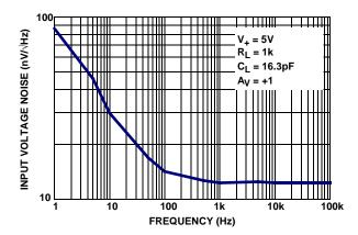
FIGURE 12. INPUT VOLTAGE NOISE DENSITY vs FREQUENCY
