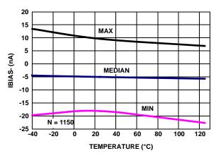
FIGURE 27. IBIAS- vs TEMPERATURE, V<sub>+</sub>, V<sub>-</sub> = ±1.2V
