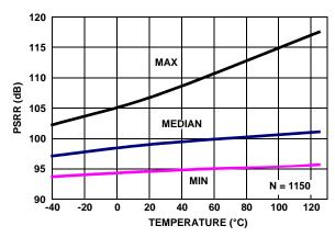
FIGURE 31. PSRR vs TEMPERATURE V<sub>+</sub>, V<sub>-</sub> = ±1.2V TO ±2.75V
