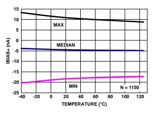
FIGURE 26.  $I_{BIAS+}$  vs TEMPERATURE,  $V_+$ ,  $V_- = \pm 1.2V$
